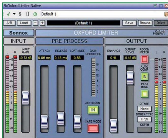
Das Sonnox Brickwall-Limiter Plug-in verfügt über ein Reconstruction Meter und zeigt Werte über 0 dB an.
