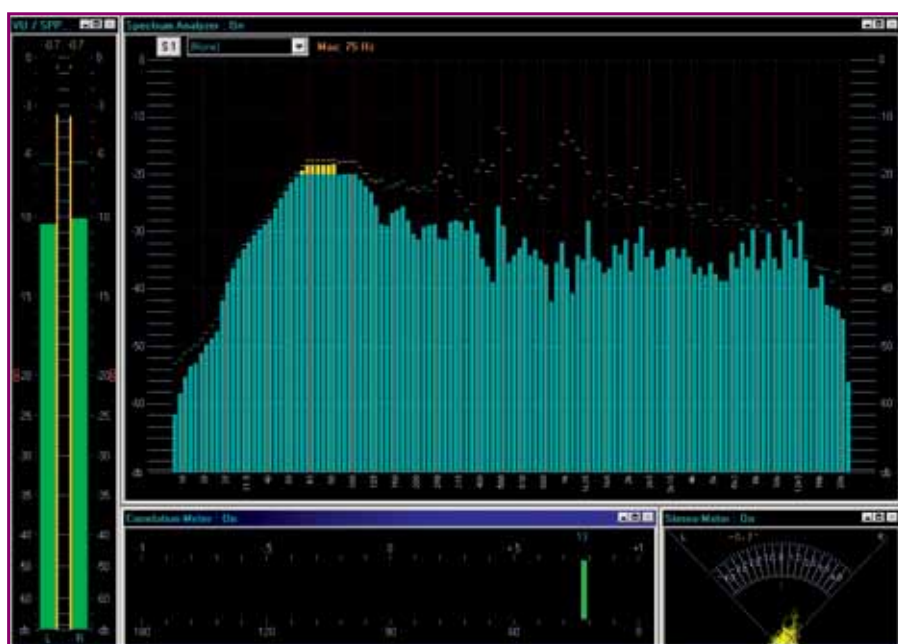
Penguin PG-AM 4.5 Audiometer ( www.masterpenguin.de ): Links senkrecht = Peak- und Lautheitsmessung; Mitte unten: Korrelationsgradmesser; unten rechts: Goniometer; groß: Grafik- oder Spektrum-Analyser.
