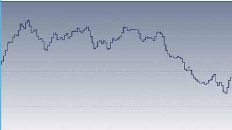
Treppenstufen der digitalisierten Wave-Datei im WaveLab.
